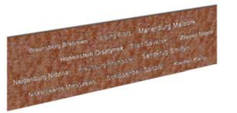
Einfassung der Heimaterden mit Corten-Stahlband (Höhe ü. GOK = 30 cm) Stahl mit ausgefrästen Herkunftsorten der Heimatreden, Bepflanzung mit niederen Bodendeckern z.B.: Sternemoos
