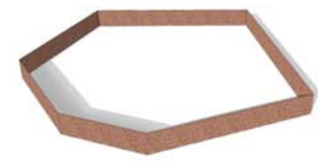
Einfassung der Heimaterden mit Corten-Stahlband (Höhe ü. GOK = 30 cm) Stahl mit ausgefrästen Herkunftsorten der Heimatreden, Bepflanzung mit niederen Bodendeckern z.B.: Sternemoos
